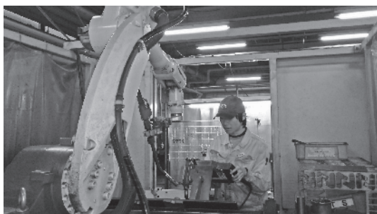
▲溶接ロボット ポジショナー付三面テーブル ティーチング作業
